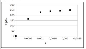
Com base nos dados da figura, se o corpo de prova for submetido a uma tensão normal de 25 MPa, a deformação será de:
