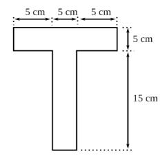
Para esta seção transversal, a coordenada vertical do centro geométrico da seção (ycg), em relação à base da seção, vale:
