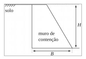
A distância entre o ponto de aplicação da resultante do empuxo do solo no muro de contenção e sua base (*B*) será de:
